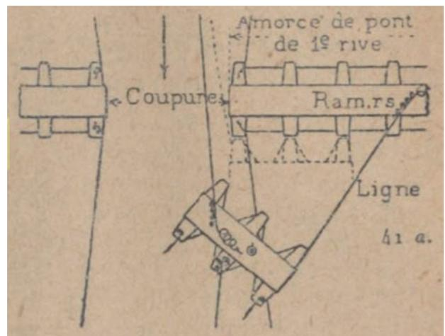
Fig. 8 : Fonctionnement d'une portière sur un pont de barques (Anonyme, 1915, chapitre VII, p. 33 ; source BNF Gallica).
